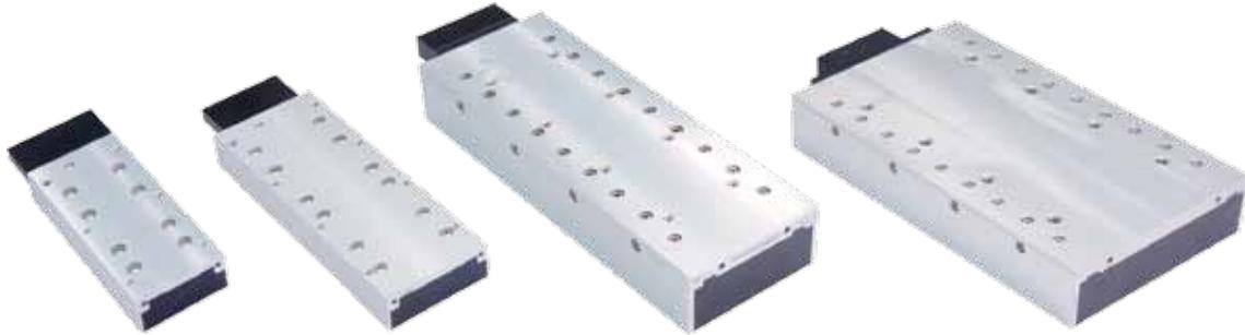
파카그룹의 Ripped Ironcore 리니어 모터는 자체 특허 출원한 코깅 현상 방지 기능을 통해 전통적 Ironcore 리니어 모터와 관련된 표면 조도 (거칠기) 현상을 일으키지 않은 상태에서 많은 산업용 어플리케이션 분야에 필수적으로 요청되는 대규모 단위의 작용력을 발생시켜 주는 바, 90 N 수준에서 최대 7,435 N 범위에 달하는 물리적 작용력을 통해 이 립형 계열 제품군은 고 난이도를 요하는 매우 광범위한 적용 분야에 매우 적합합니다.
